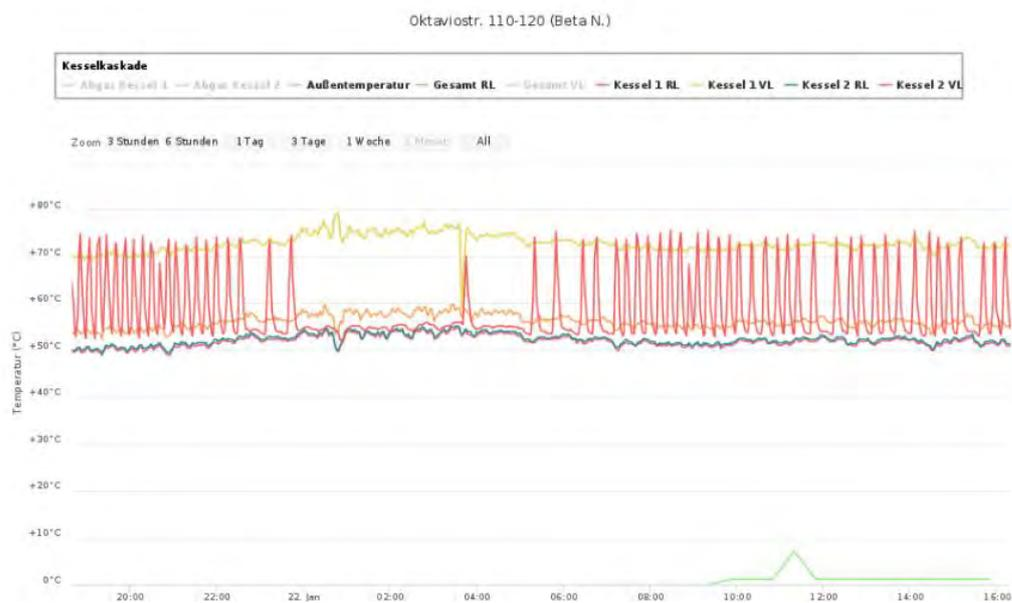
Abbildung 28. Taktverhalten von Kessel 2 in der Oktaviostr. 110-120
