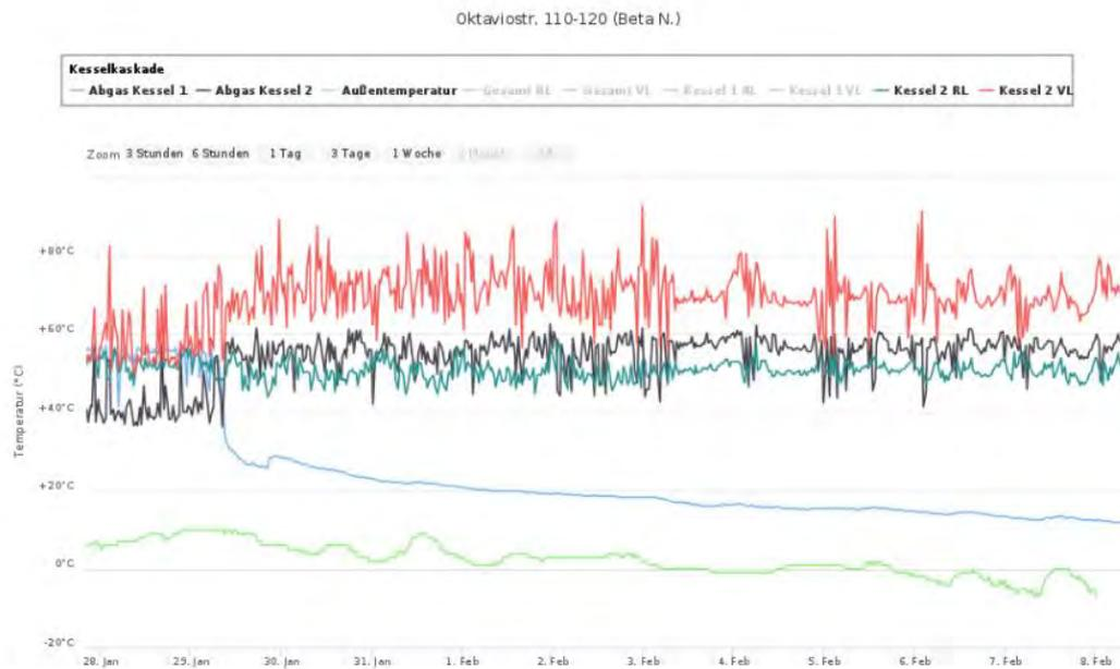
**Abbildung 29.** Defekter Kessel in der Oktaviostr. 110-120
